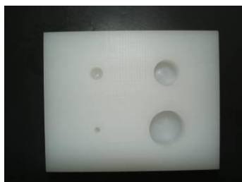
Ferramenta de inserção da Ponta de teflon da seringa
