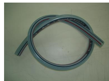
Mangueira para saída de resíduo alta e baixa concentração (diâmetros interno e externo: 15x22 mm)
