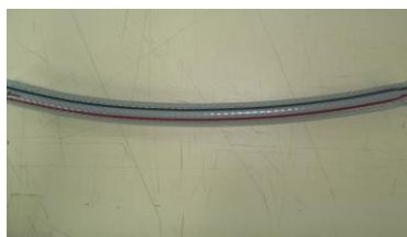
Mangueira para entrada de água deionizada (diâmetros interno e externo: 12x18mm)
